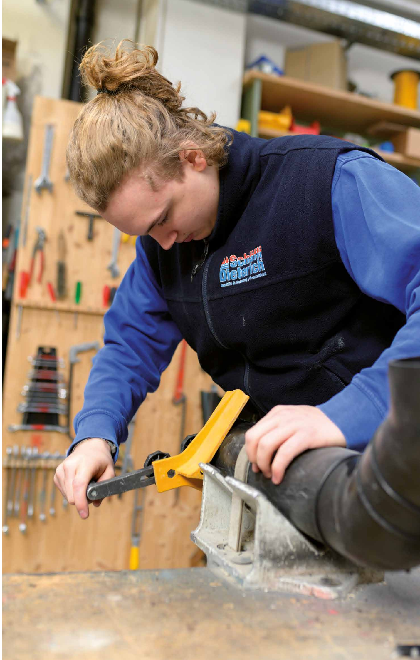
Steven Bäggl coupe un tuyau d'évacuation des eaux usées.
