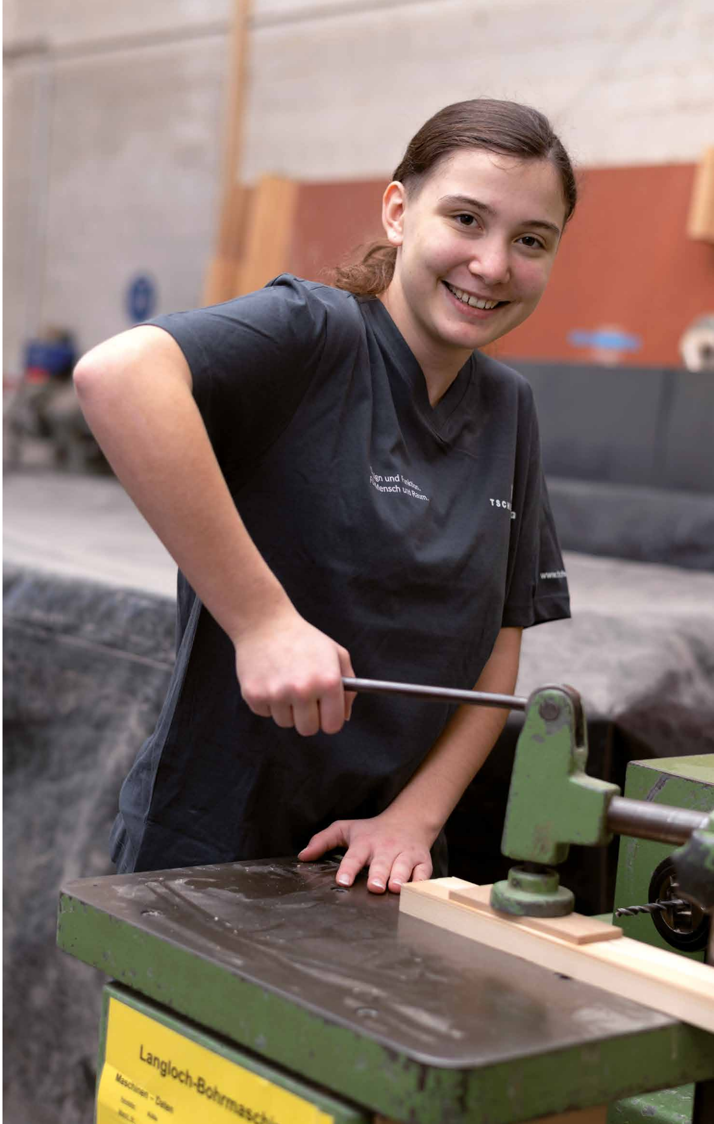
Arlene Haller beim Einspannen eines Werkteils in die Langlochbohrmaschine.
