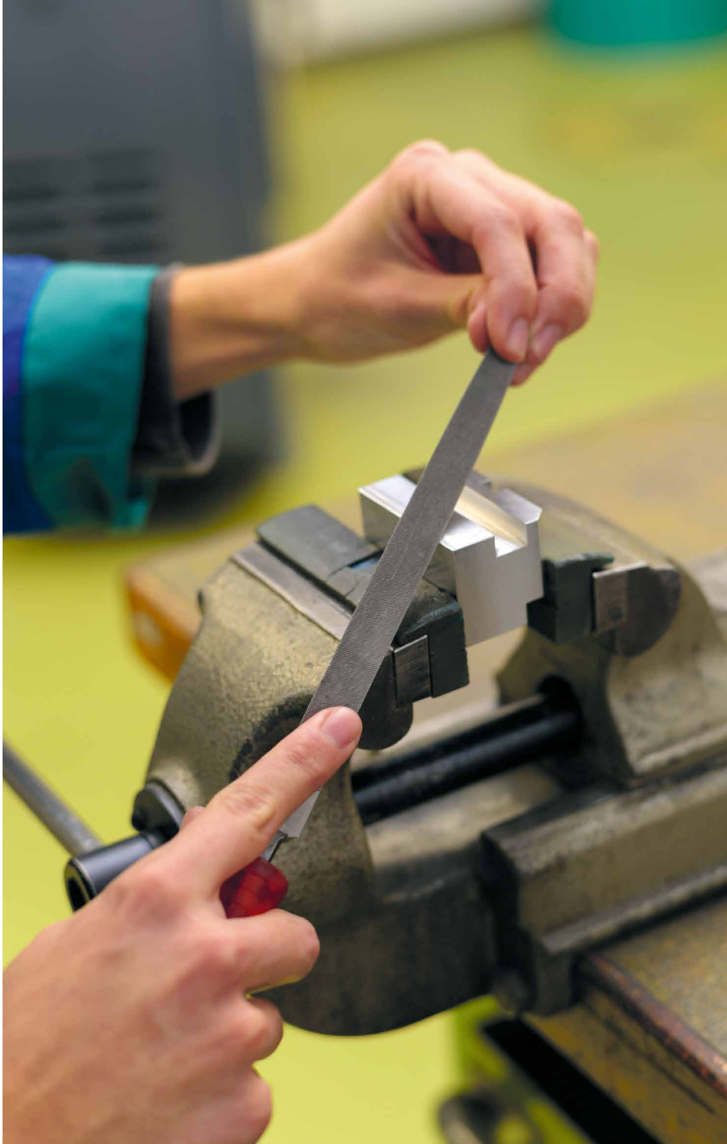
Das Feilen einer Aluminiumkomponente am Schraubstock braucht viel Präzision.
